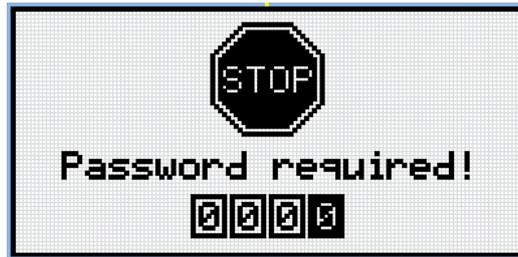
**Hinweis:** Vor der Änderung des Passworts muss die Steuerung entriegelt werden. Falls die Steuerung verriegelt ist, zeigt die Steuerung den Bildschirm Passwort benötigt! In diesem Fall muss das Passwort eingegeben werden, bevor das Passwort geändert wird.
